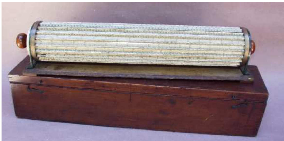
Ο κυλινδρικός λογαριθμικός κανόνας Thatcher
